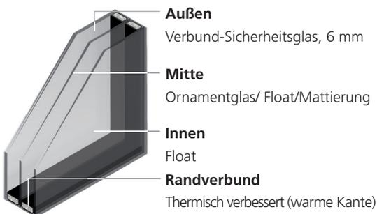
3-fach-Verglasung =  $U_g 0,6 \text{ W}/(\text{m}^2\text{K})$
