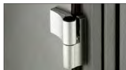
3 zweiteilig, aufliegende Türbänder, dreidimensional verstellbar, in EV1 (bei Türen in RAL 9016 FS: Verkehrsweiß Feinstruktur matt, bei RAL 8077 FS: Dunkelbronze eloxiert)
